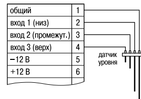
Подключение кондуктометрических датчиков уровня
