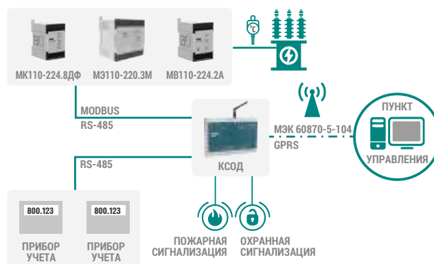
Система телемеханики трансформаторной подстанции 6(10)/0,4 кВ
