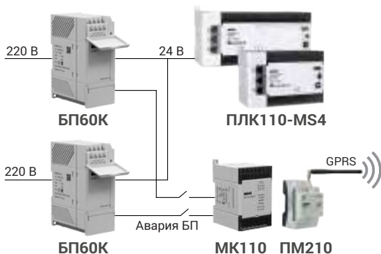
Питание ПЛК с резервированием и удаленным контролем состояния питания в SCADA или OwenCloud
