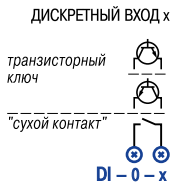
Схема подключения дискретных входов ПЛК100
