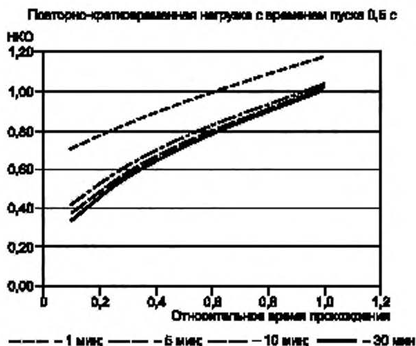
Рисунок E.7 — Графический пример соотношения между эквивалентным НКО и параметрами при повторно-кратковременном режиме t_1 = 0,5 с, I_1 = 7 \times I_2 для разного времени цикла
