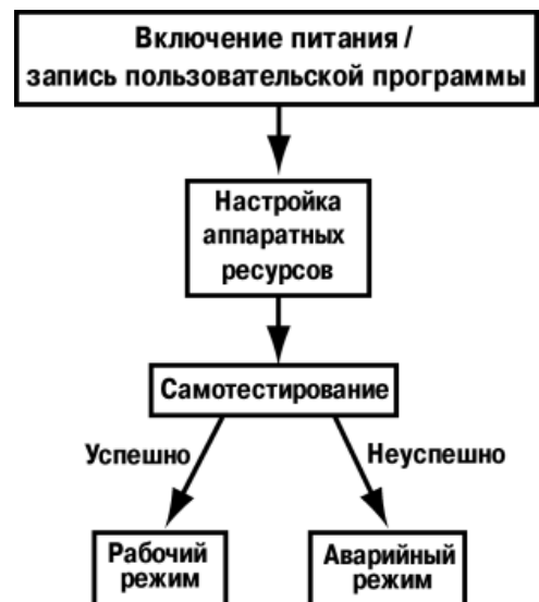
Рисунок 4.2 – Алгоритм запуска прибора
