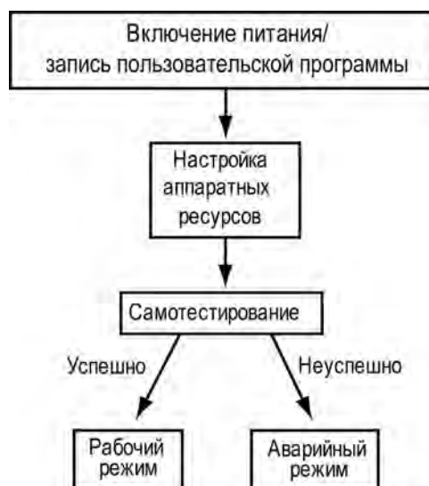
Рисунок 6.2 – Алгоритм запуска прибора
