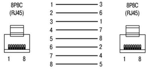
Рисунок Г.4 – Разводка кабеля для соединения ПЛК с компьютером по сети Ethernet напрямую
