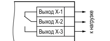
Рисунок 11 – Подключение нагрузки к ВУ типа «Р»
