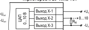
Рисунок 30 – Схема подключения нагрузки к ВУ типа «У» Сопротивление нагрузки R_n , подключаемой к ЦАП, должно быть не менее 2 кОм и не более 10 кОм.
