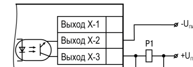
Рисунок 24 – Схема подключения нагрузки к ВУ типа «К»
