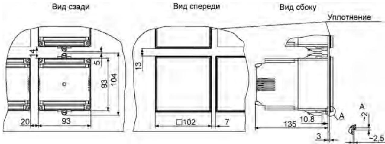
**Рисунок Б.3 – Размеры TPM32-Щ4, установленного в щит толщиной 3 мм**
