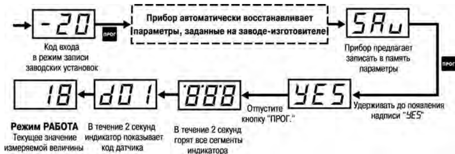
Рисунок 4.2 – Схема действий при восстановлении заводских установок
