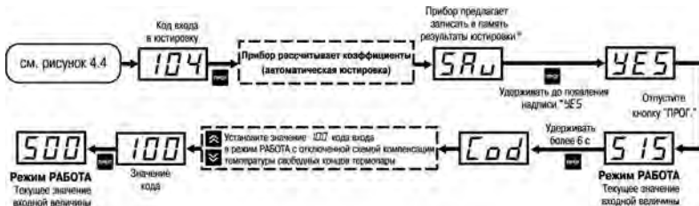
Рисунок Д.6 – Последовательность действий при юстировке схемы прибора с термопарой
