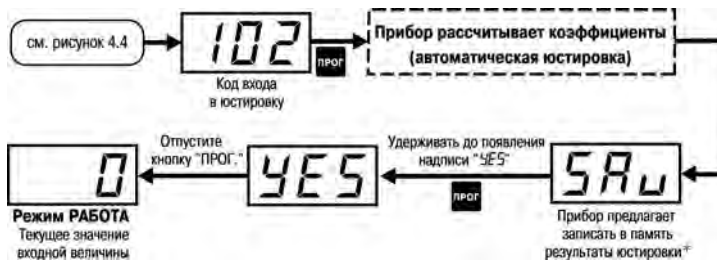
Рисунок Д.8 – Последовательность действий при юстировке схемы компенсации температуры свободных концов термопары
