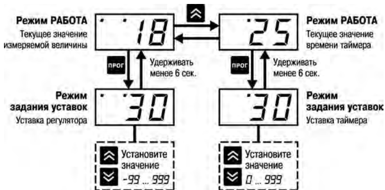
Рисунок 4.3 – Схема задания уставок регулятора и таймера
