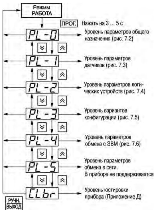
Рисунок 6.1 – Схема выбора уровня программируемых параметров
