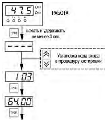
Рисунок 8.2 – Последовательность работы при юстировке
