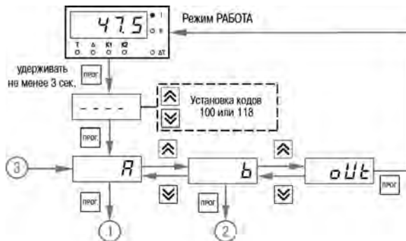
Рисунок 7.2 – Последовательность работы с прибором на втором уровне настройки
