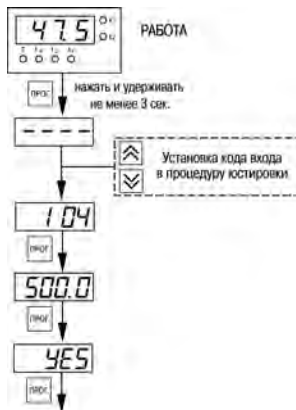
Рисунок 8.4 – Последовательность работы при юстировке
