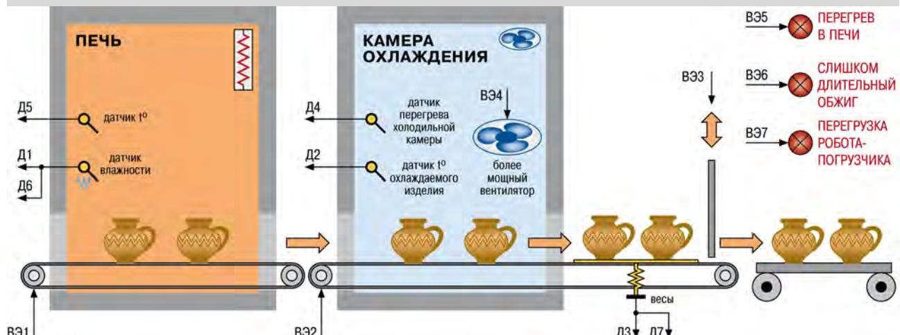
Рисунок 7.4 – Использование 8-канального регулятора TPM148 2-ой модификации в автоматизированном процессе обжига глиняных изделий
