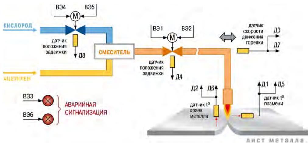
Рисунок 7.15 – Использование 8-канального регулятора TPM148 6-ой модификации в производственной автоматизированной установке резания листов из металлических сплавов
