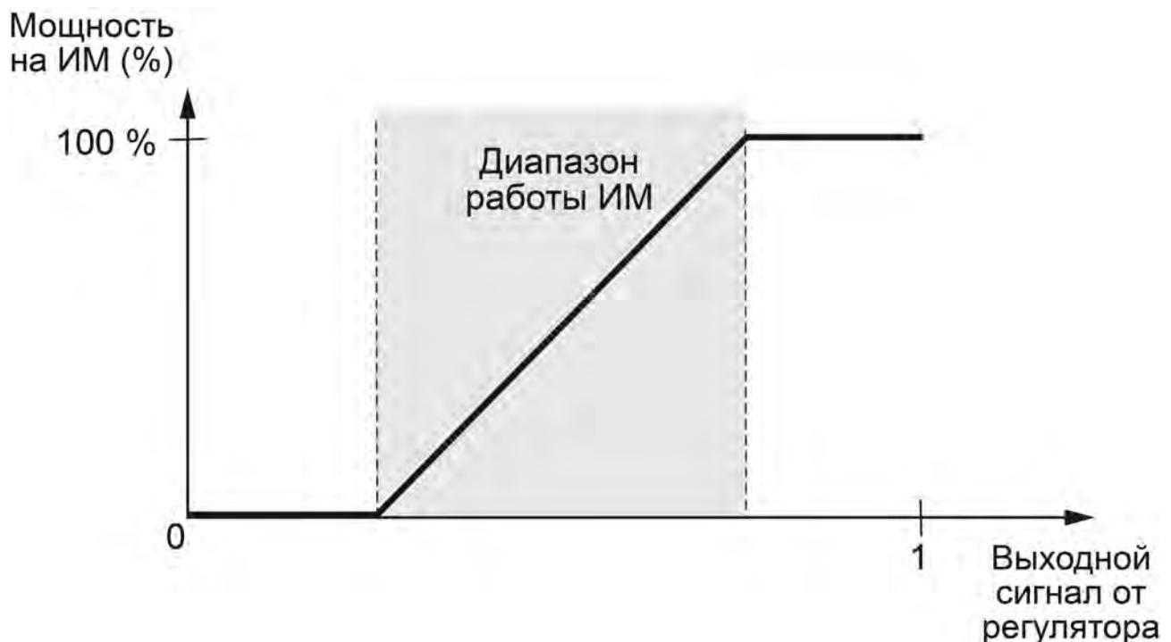
**Рисунок 9.39 – Работа ИМ (тип «Нагреватель») в заданном диапазоне**
