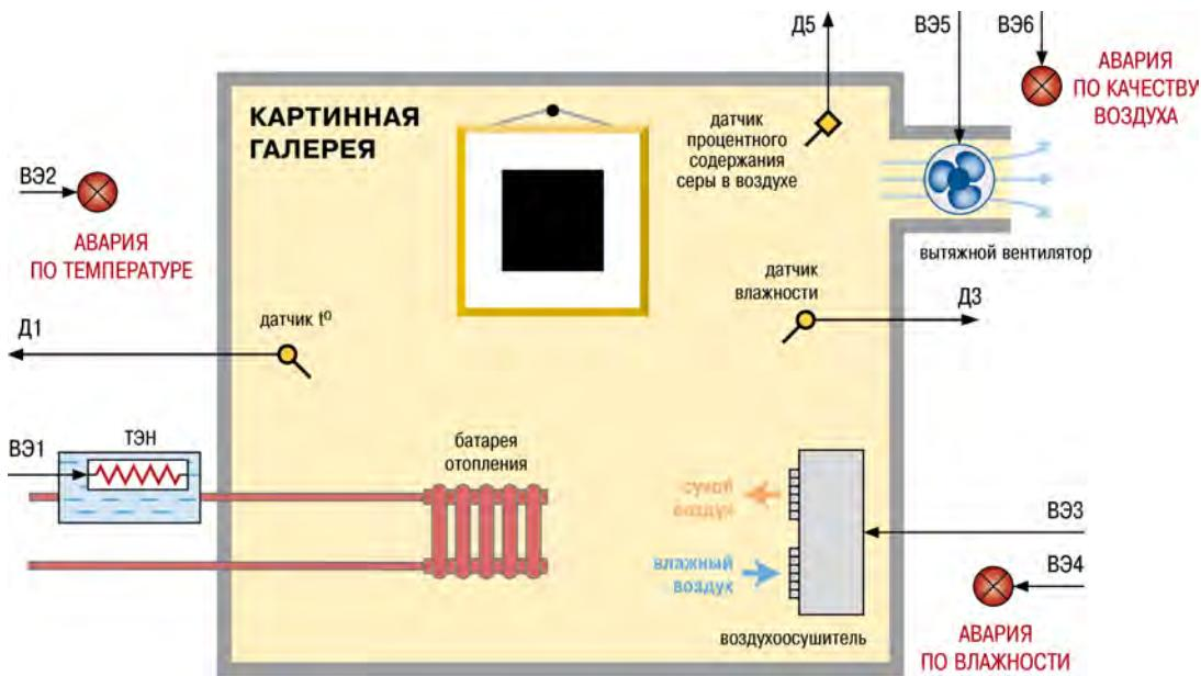
Рисунок 7.10 – Использование 8-канального регулятора TPM148 4-ой модификации в системе жизнеобеспечения выставочного зала картин
