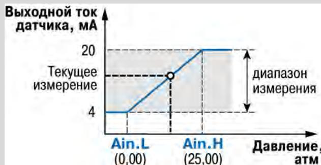
Рисунок 9.9 – Пример задания диапазона измерения активного датчика
