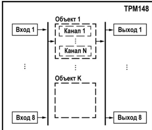
**Рисунок 6.1 – Общая функциональная схема прибора**
