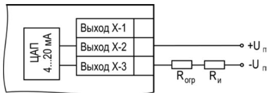
Рисунок 5.19 – Схема подключения нагрузки к ВУ типа И
