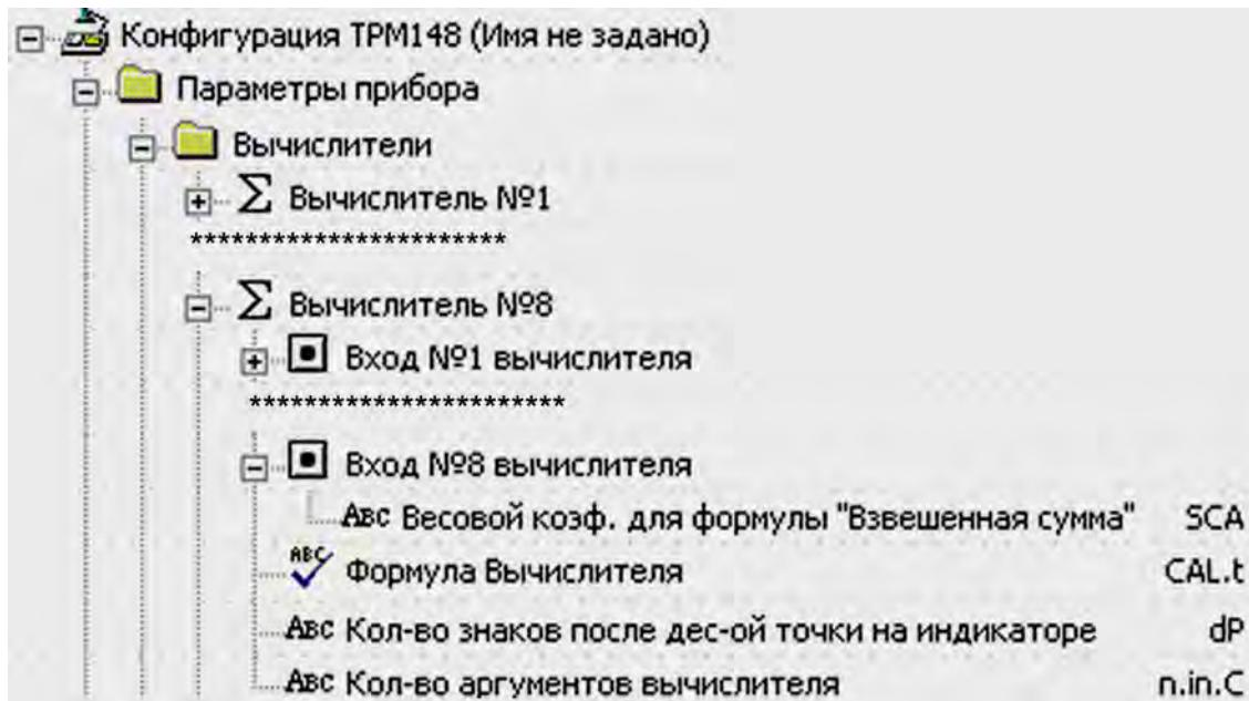
Рисунок 9.12 – Конфигуратор. Настройка связей входов прибора с Вычислителями
