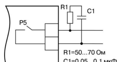
**Рисунок 5.10 – Схема подключения нагрузки к ВУ типа Р**
