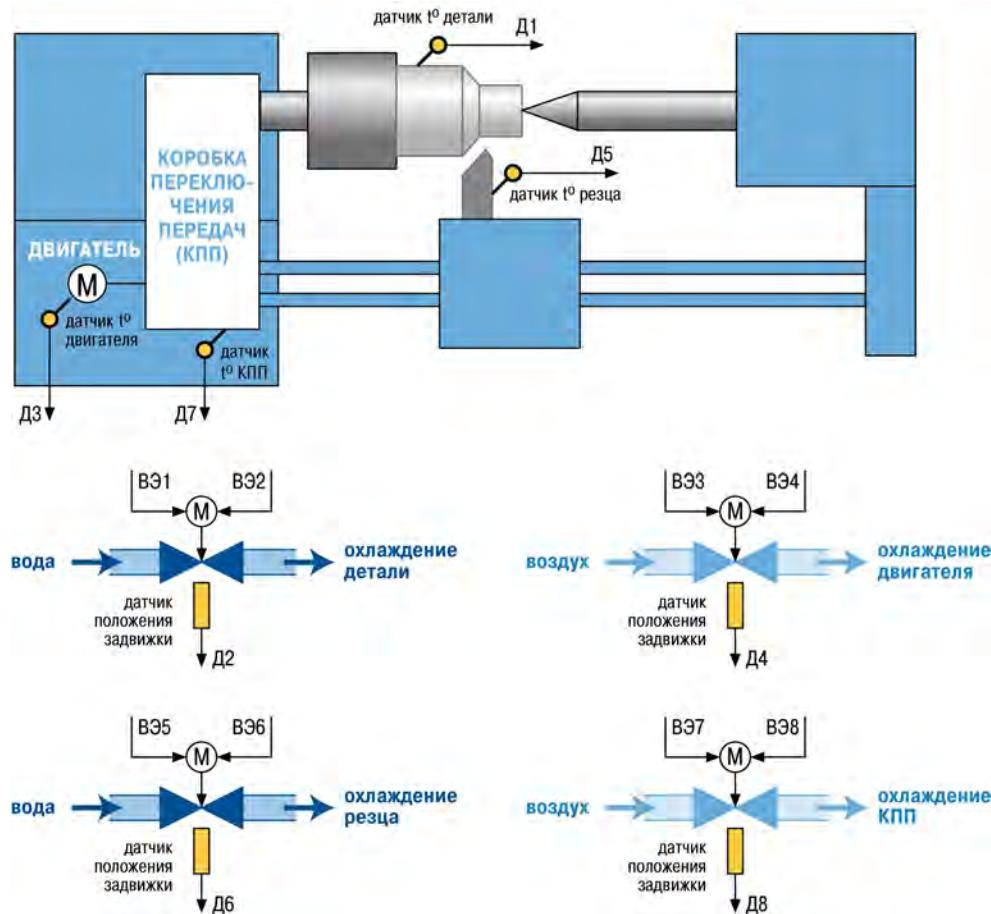
**Рисунок 7.7 – Использование 8-канального регулятора TPM148 3-ой модификации в технологической системе управления охлаждением станка для точной обработки деталей**
