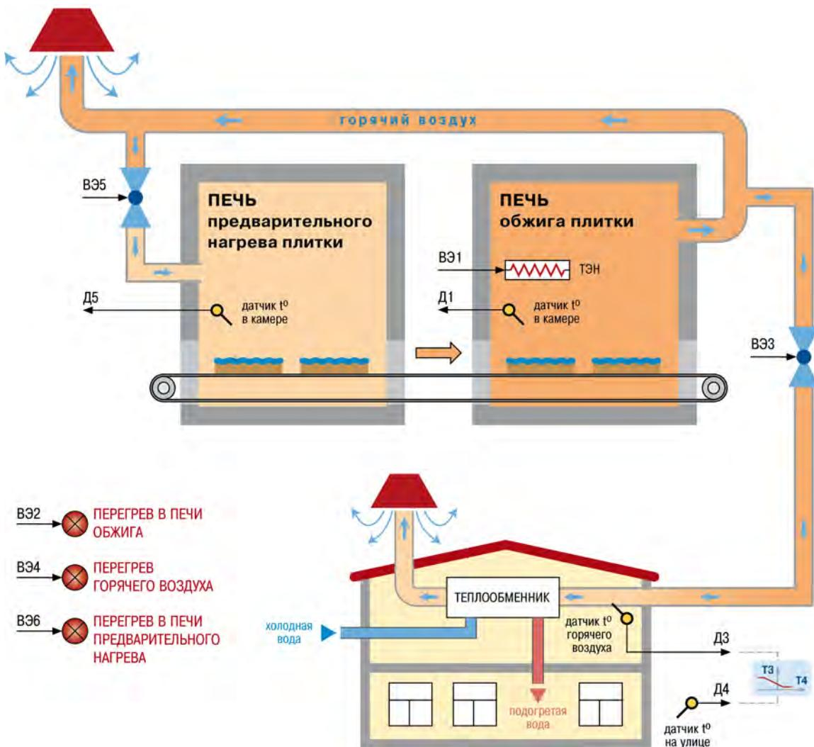
Рисунок 7.13 – Использование 8-канального регулятора TPM148 5-ой модификации в системе термообработки (обжига) керамической плитки
