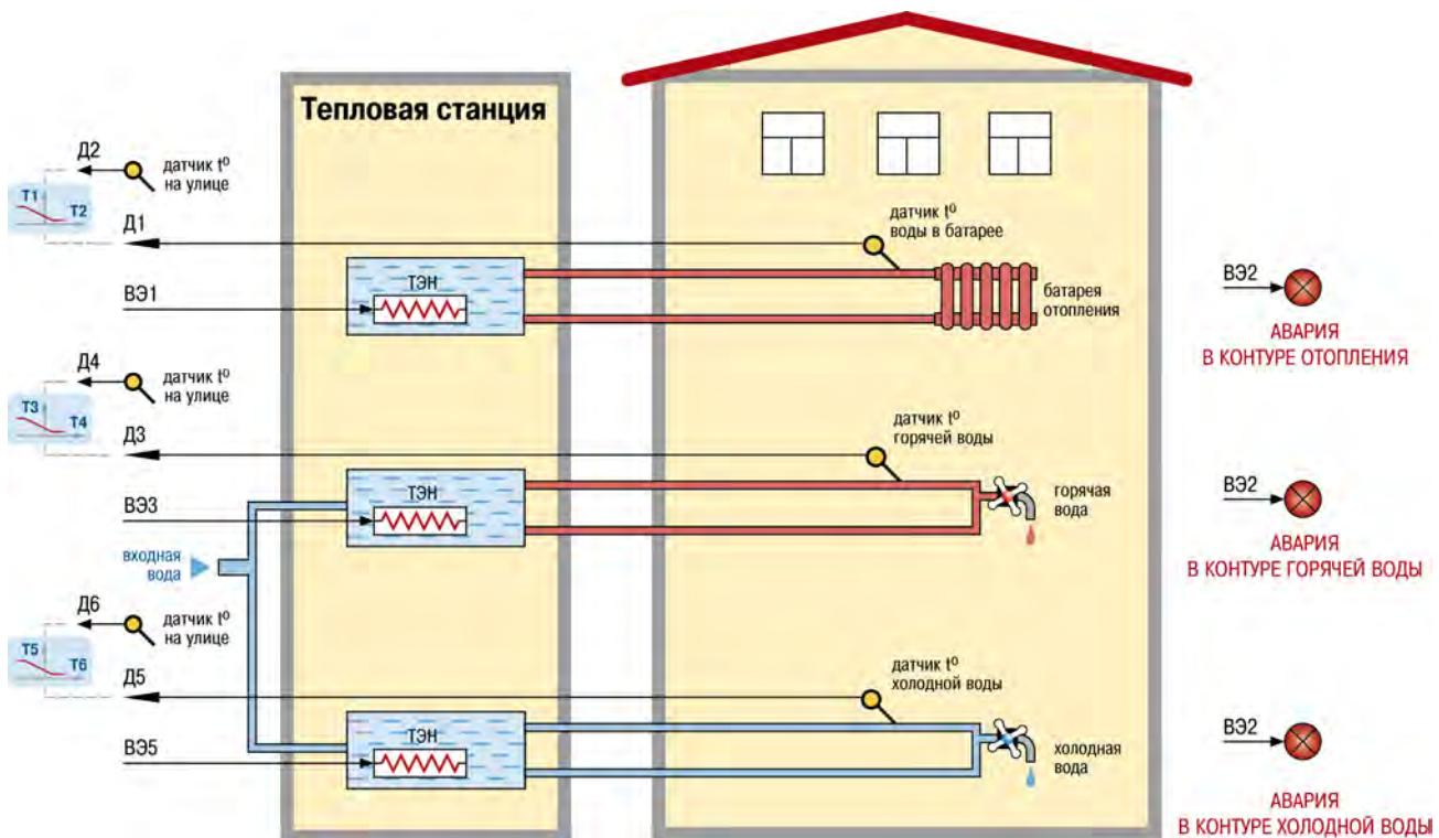
**Рисунок 7.12 – Использование 8-канального регулятора TPM148 5-ой модификации в системе теплоснабжения здания**
