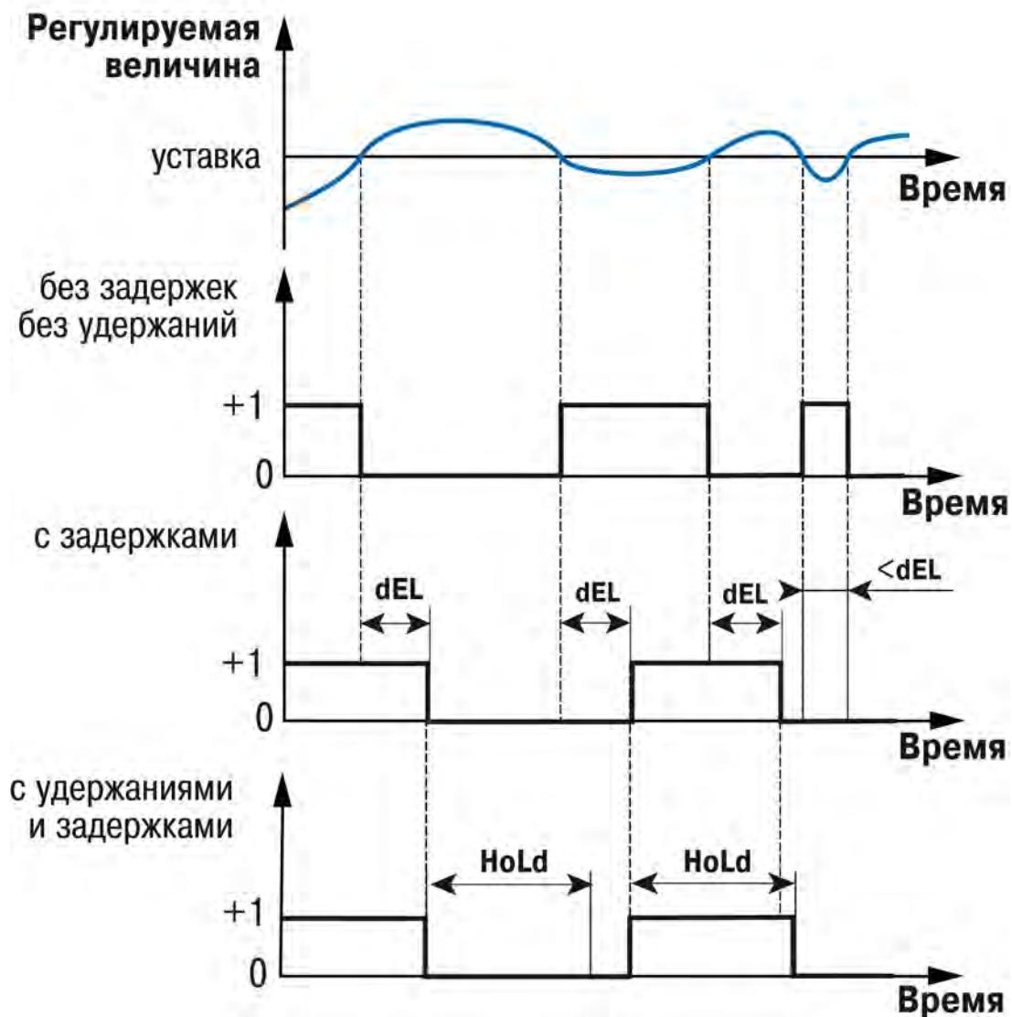
Рисунок 9.29 – Работа регулятора с заданными задержками и удержаниями
