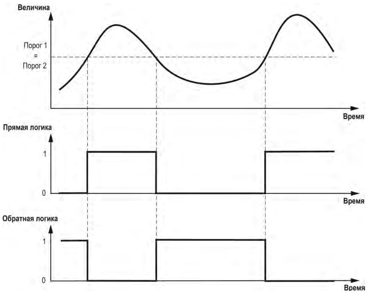
**Рисунок 9.54 – Работа Инспектора по прямой и обратной логикам**
