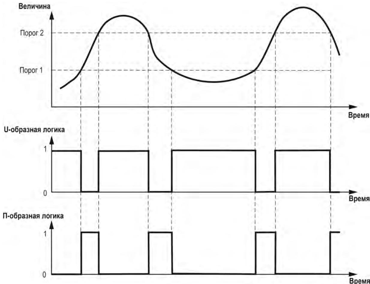
Рисунок 9.53 – Работа Инспектора по U-образной и П-логикам
