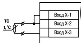
Рисунок 5.4 – Двухпроводная схема подключения ТС
