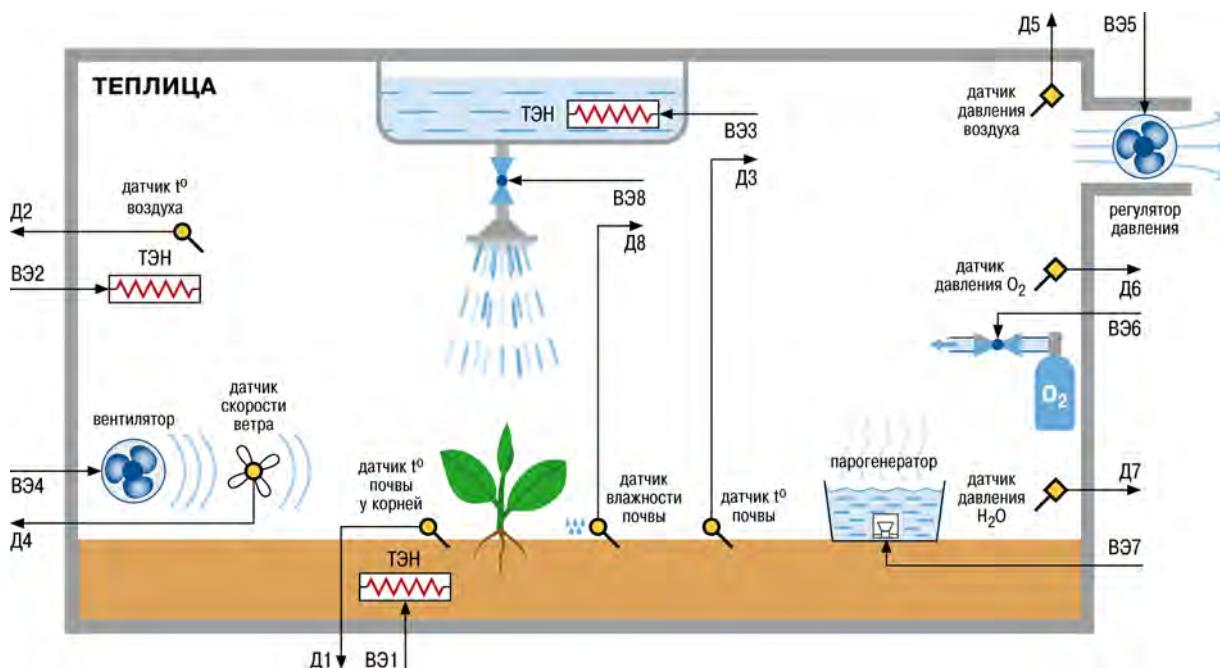
**Рисунок 7.2 – Использование 8-канального регулятора TPM148 1-ой модификации для поддержания в заданных диапазонах величин параметров жизнедеятельности теплицы для испытания выживаемости растений**
