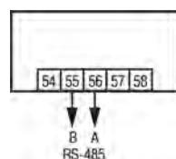
Рисунок 5.22 – Схема подключения для интерфейса RS-485
