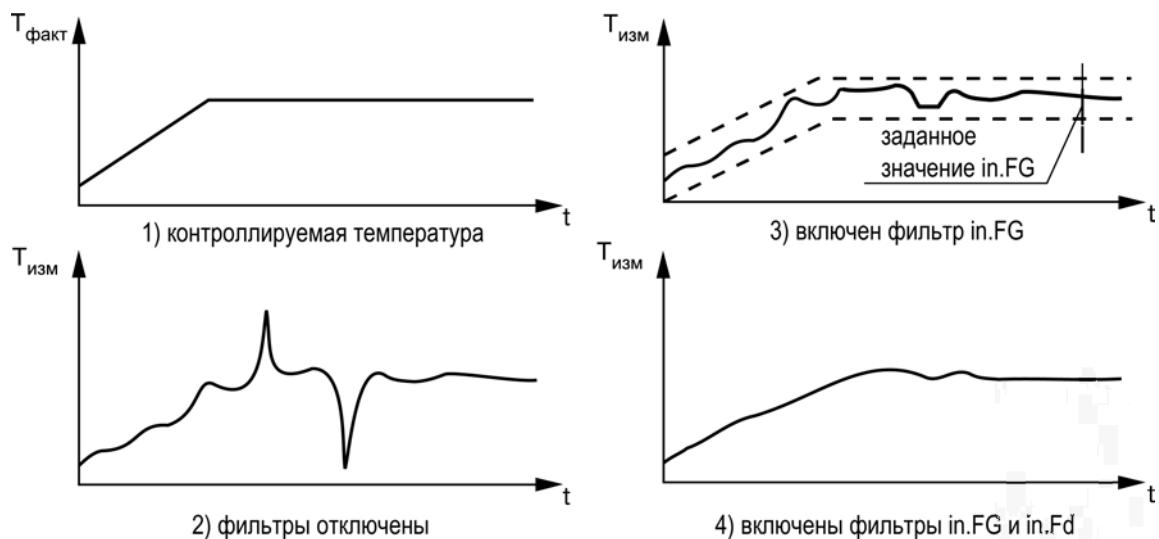
Рисунок 9.1 – Временные диаграммы работы цифровых фильтров
