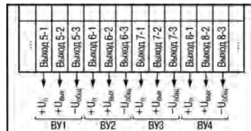
Рисунок 5.21 – Схема подключения выходных устройств прибора
