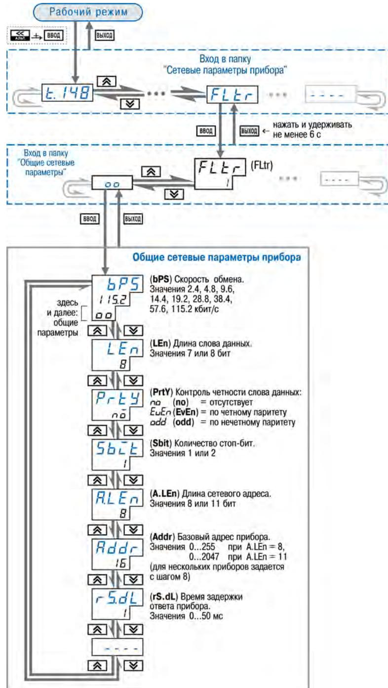
Рисунок 8.5 – Схема задания сетевых параметров прибора кнопками на лицевой панели прибора
