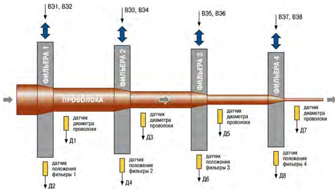
Рисунок 7.8 – Использование 8-канального регулятора TPM148 3-ой модификации в управляемой автоматизированной системе из четырех фильтров для получения проволоки
