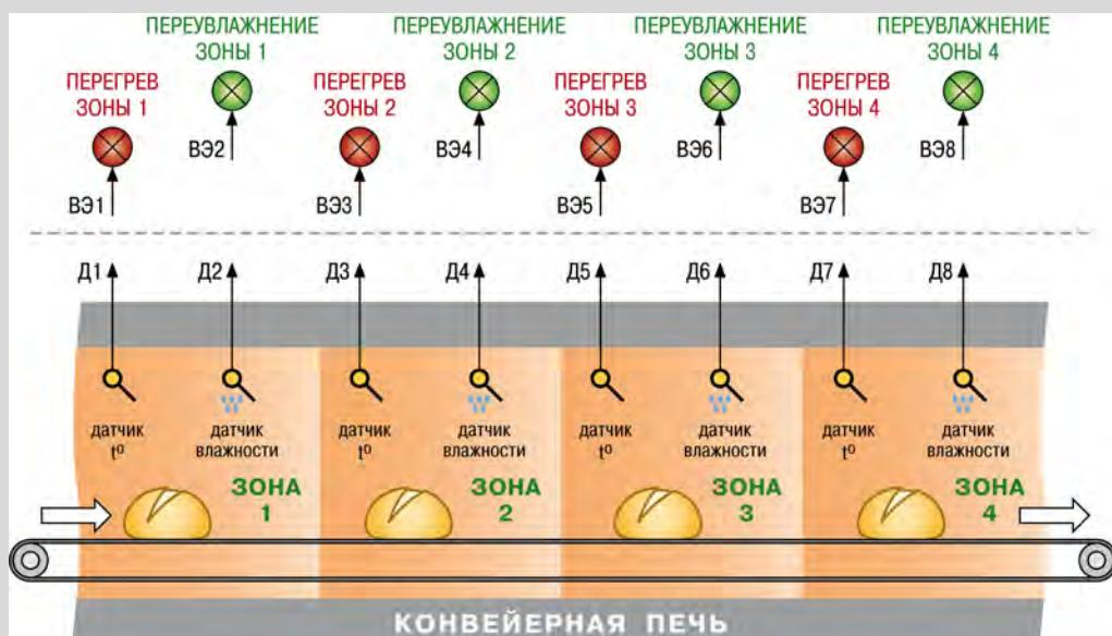
**Рисунок 7.5 – Использование 8-канального регулятора TPM148 2-ой модификации в системе сигнализации автоматизированного технологического процесса выпекания хлебо-булочных изделий**
