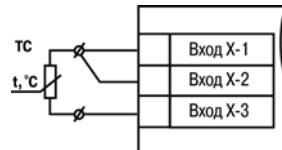
Рисунок 5.3 – Трехпроводная схема подключения ТС
