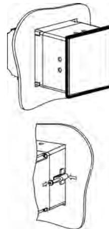
**Рисунок 4.1 – Монтаж прибора**
