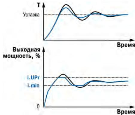
Рисунок 9.17 – ПИД-регулирование
