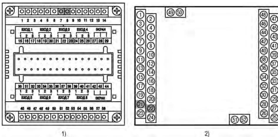
Рисунок 5.2 – Клеммники: TPM148-X (1) и Клеммник TPM148-X.W7 (2)
