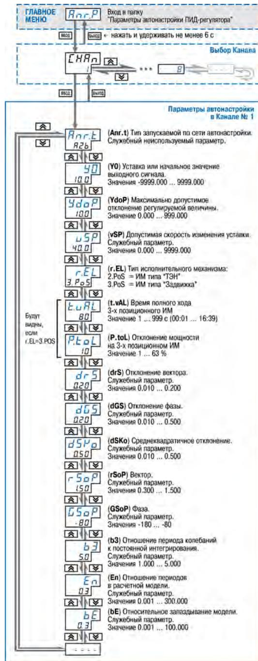
Рисунок 8.29 – Схема задания параметров Автостройки ПИД-регулятора
