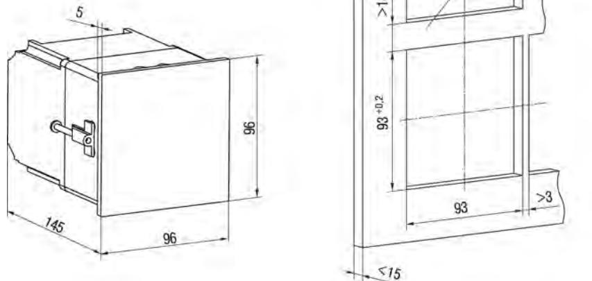
**Рисунок 4.2 – Габаритные размеры корпуса Щ4**
