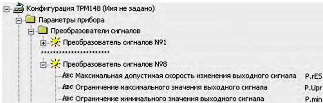
Рисунок 9.32 – Конфигуратор. Задание диапазона выходного сигнала
