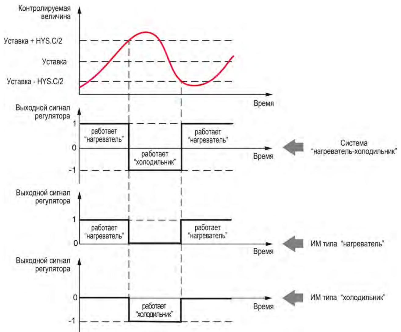
**Рисунок 9.22 – Принцип работы Двухпозиционного регулятора**
