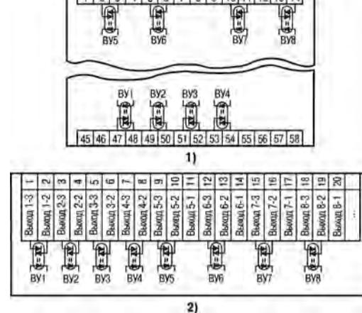
Рисунок 17 – Схема подключения симисторных оптопар прибора: 1) в корпусе Щ4, 2) в корпусе Щ7
