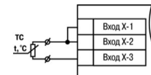
Рисунок 8 – Двухпроводная схема подключения ТС
