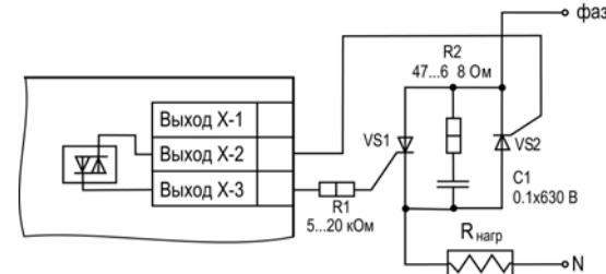
Рисунок 16 – Схема встречно-параллельного подключения двух тиристоров к ВУ типа С
