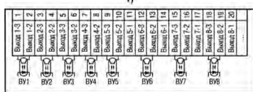
Рисунок 14 – Схема подключения транзисторных оптопар прибора: 1) в корпусе Щ4, 2) в корпусе Щ7
