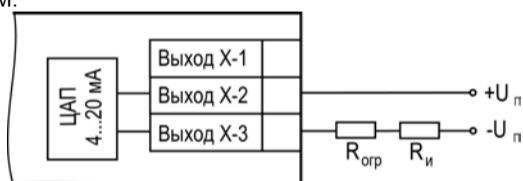
Рисунок 13 – Схема подключения нагрузки к ВУ типа И
