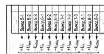
Рисунок 21 – Схема подключения выходных устройств прибора
