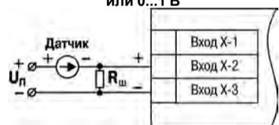
Рисунок 12 – Схема подключения пассивного датчика с токовым выходом 0...5 мА или 0 (4)...20 мА Rsh=100,000 ± 0,025 Ом
