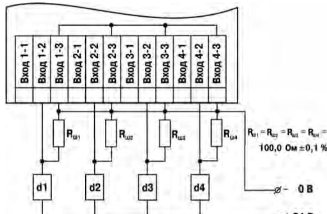
Рисунок 10 – Пример схемы подключения активных датчиков d1 - d4 с выходным сигналом тока от 4 до 20 мА
