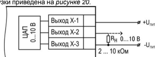
Рисунок 20 – Схема подключения нагрузки к ВУ типа У
