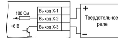
Рисунок 18 – Схема подключения нагрузки к ВУ типа Т
