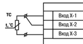
Рисунок 7 – Трехпроводная схема подключения ТС
