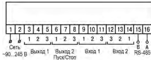
Рисунок 5.2 – Общая схема подключения TPM210-N, -Щ1 и -Щ2
