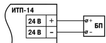
Рисунок 5.1 – Схема подключения к источнику питания
