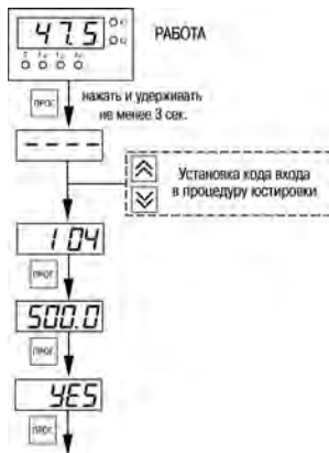
Рисунок 8.2 – Последовательность работы при юстировке
