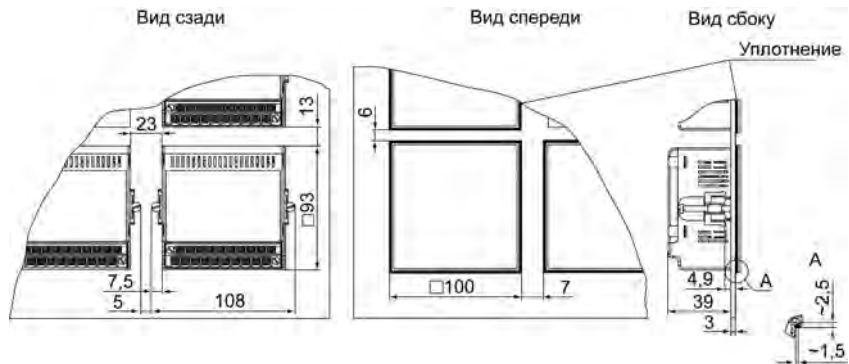
Рисунок 4.11 – Прибор в корпусе Щ11, установленный в щит толщиной 3 мм
