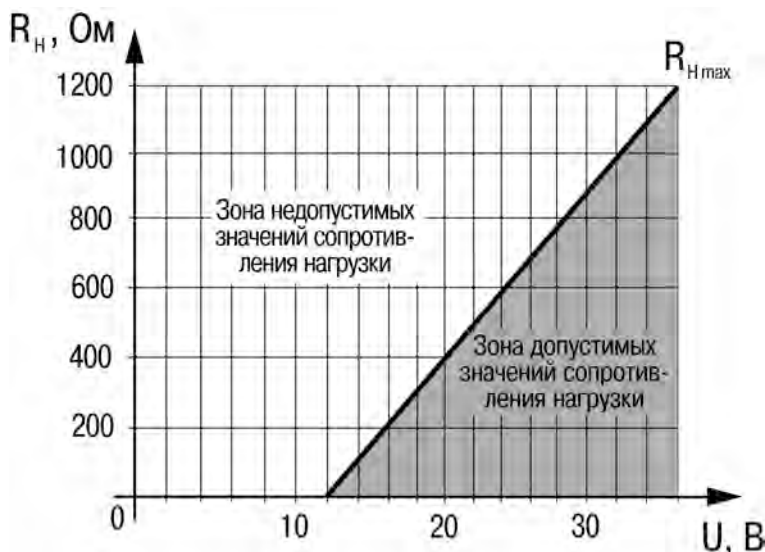
Рисунок 2.1 – График для выбора допустимых значений сопротивления нагрузки
