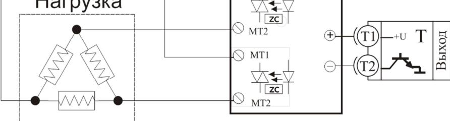
Схема подключения силового блока к нагрузке,
