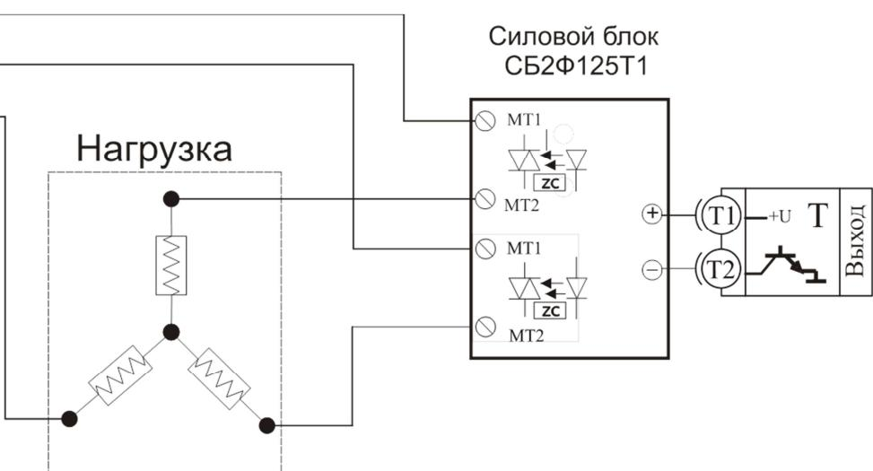
Схема подключения силового блока к нагрузке,
