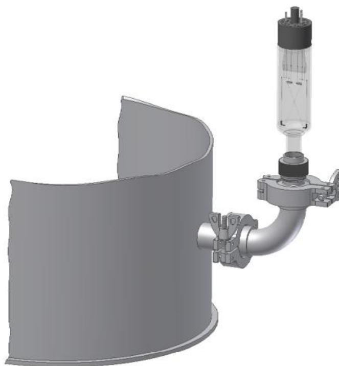
Схема подключения датчика ПМТ-2 к вакуумной системе
