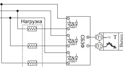
Подключение трехфазной нагрузки
