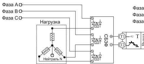
Управление трехфазной нагрузкой
