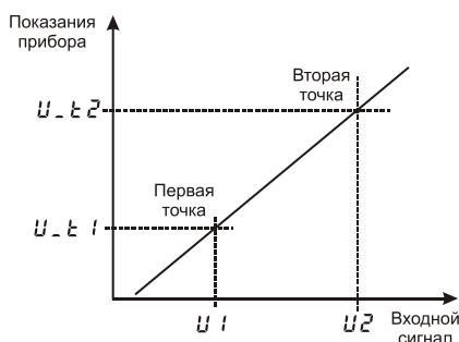
по квадратичной зависимости для входа типа **Prbl** и с извлечением квадратного корня для входа типа **Sqrt**. Линия задаётся двумя точками. Датчики с унифицированным токовым выходом 4...20 мА подключаются к входу прибора через шунт 2 Ом.
