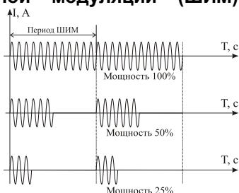
**При методе равномерно распределенных рабочих сетевых периодов (РСП)** ток через нагреватель периодически включается на один или несколько сетевых периодов. Мощность нагревателя испытывает меньшие колебания во времени, чем при использовании ШИМ. Этот метод очень хорош в лабораторных условиях при малых мощностях нагревателя. Не используйте метод при мощностях более 5 кВт. Недопустимо использование метода РСП при индуктивной нагрузке.
