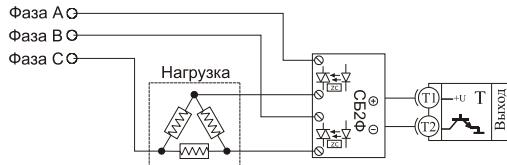
Использование двухфазных силовых блоков
