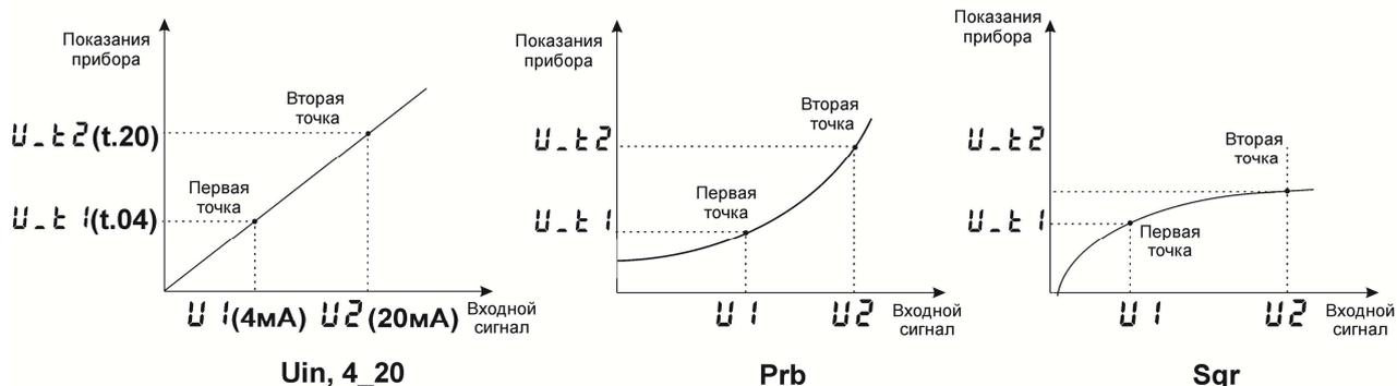
Данный раздел доступен только для тех каналов, на которых установлен датчик **U\_in**. При подключении датчиков с выходом по току или по напряжению прибор может пересчитать значение напряжения на входе в значение измеряемой величины.
