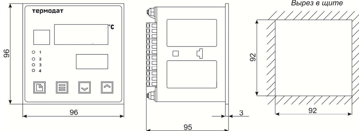
**Габаритные размеры прибора 22K5/.../IP67пп**
