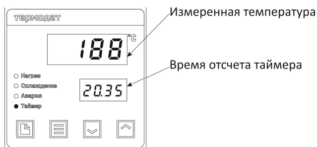
Рисунок 6 – Описание индикаторов при настройке таймера Термодат-10К7-А
