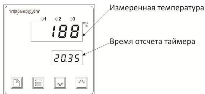
Рисунок 7 – Описание индикаторов при настройке таймера Термодат-10К7-М
