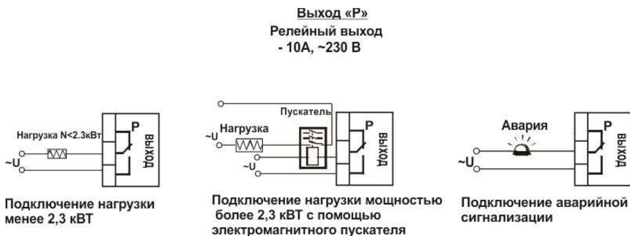
Рисунок 9 – Схемы подключения релейных выходов.
