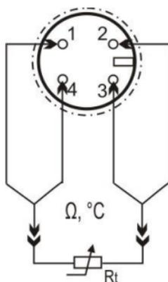
Вид на разъем с нижней торцевой поверхности прибора
