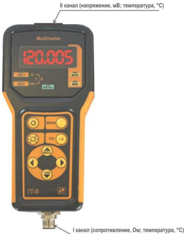
Рисунок 1 – Мультиметр IT-8-RUT
