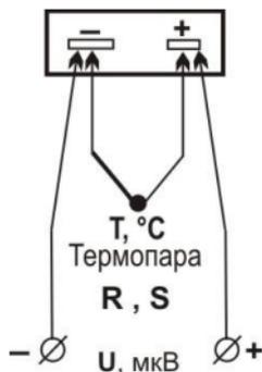
Вид на разъем с верхней торцевой поверхности прибора
