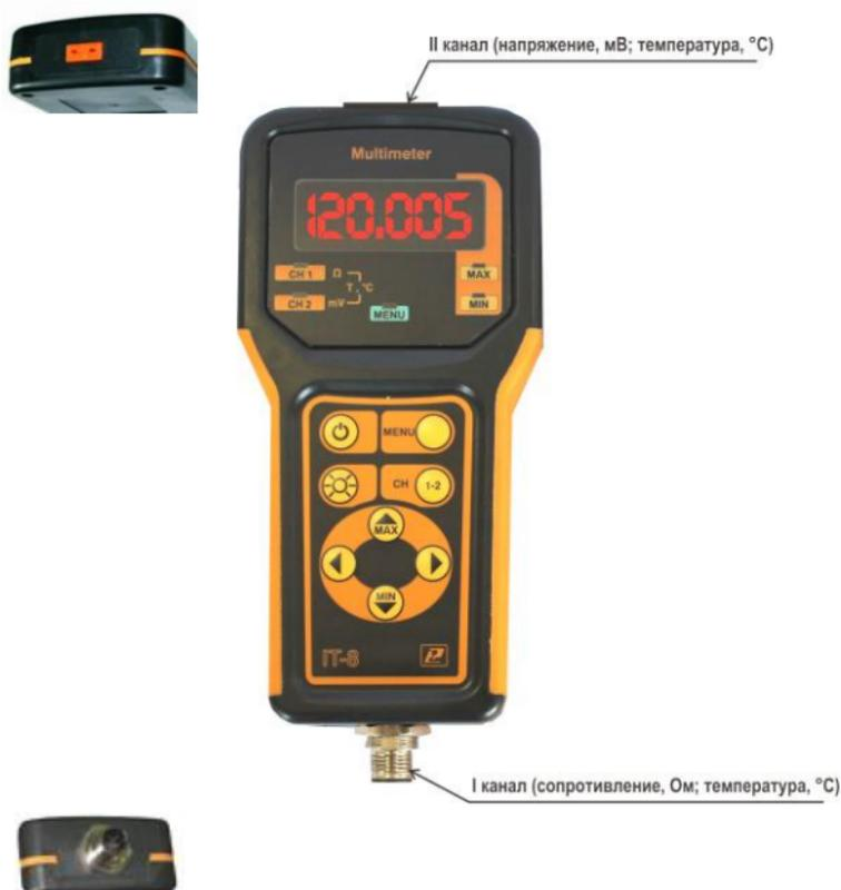
На верхней торцевой поверхности прибора плоский соединитель с 2-мя контактами.
