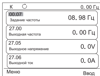
Рисунок 4.23 – Меню редактирования монитора состояния
