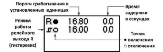
Рисунок E. Экран «relay» с параметрами работы релейных выходов
