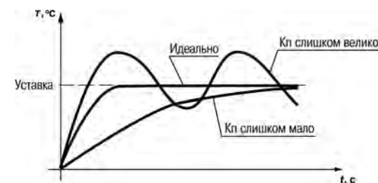
Рисунок Б.1 – Влияние K_{\text{П}} на выход на уставку
