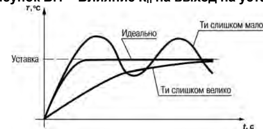
Рисунок Б.2 – Влияние T_{\text{и}} на выход на уставку
