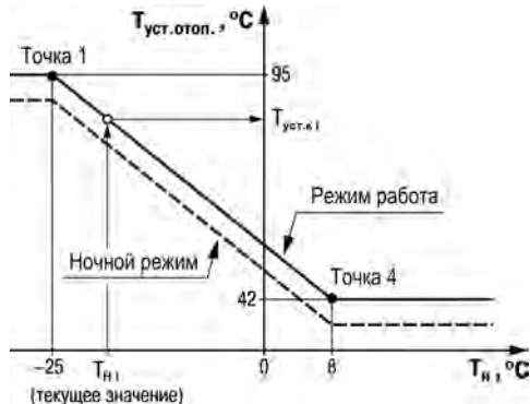
Рисунок 9.3 – График зависимости температуры сдвига от наружной температуры
