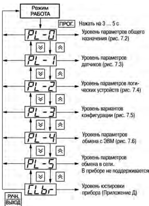
Рисунок 6.1 – Схемы выбора уровня программируемых параметров
