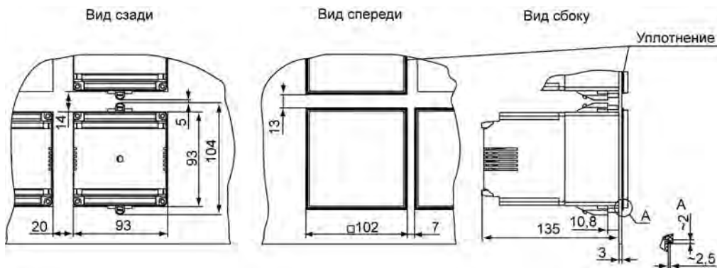
Рисунок А.2 – Габаритный чертеж TPM138В, установленного в щит толщиной 3 мм
