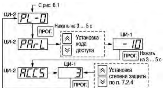
Рисунок 7.1 – Схема установки степени защиты
