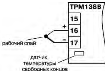
Рисунок 3.3 – Схема подключения ТП
