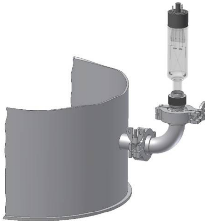
Схема подключения датчика ПМТ-2 к вакуумной системе
