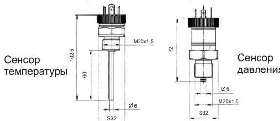
Рисунок 2 - Габаритные и установочные размеры сенсоров
